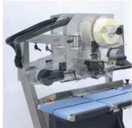
Etiketpositie bepalen door breedteverstelling van de printer
