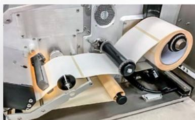
Fotosensore a barriera, unico nel suo genere, per il riconoscimento automatico di etichette di diverse forme e dimensioni.
