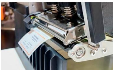
Individuelle Anpassung der Andruckkraft sowie der Kraftverteilung für einen perfekten Etikettenabdruck.
